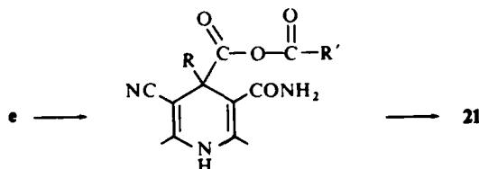
Des fragmentations analogues ont été observées en série dihydrobenzène<sup>8</sup> et dihydropyridine.<sup>1</sup> Notons que la pyridine **21** n'est présente qu'à l'état de trace dans les décompositions effectuées sous reflux dans l'acide acétique. En série 4-H nous n'avons pas pu isoler le produit de structure (**d**), même dans des conditions douces de réaction.
